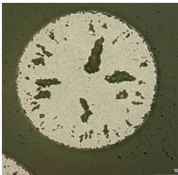
Bild 10: Typische Polysulfon-faser mit Vakuolen
