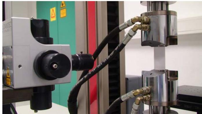
Bild 7: Versuchsaufbau kurze Laserarme und passendes Objektiv zur Erfassung der gesamten Probenfläche
