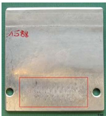
Bild 5: Al-Druckgussteil; Lage des Laminates (rote Markierung)
