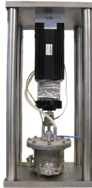
Bild 1b: Messstand: Teilansicht des Linearmotors und der Probenkammer
