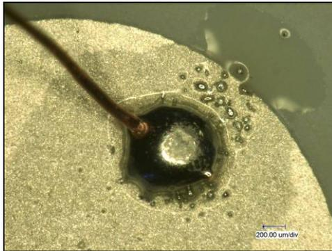
Bild 7: Durch Laserlöten kontaktiertes LTCC-Substrat (IKTS Dresden), Lot: Sn96,5Ag3Cu0,5;  $T_m=220^\circ\text{C}$
