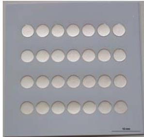
Bild 7: Test-Löt laminat mit 28 Pads aus Silber (Pad-Durchmesser: 5 mm)
