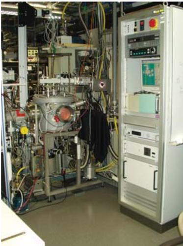
Anlage zur Abscheidung der Isolator- und Elektrodenschichten mittels PECVD bzw. Magnetron-sputtern
