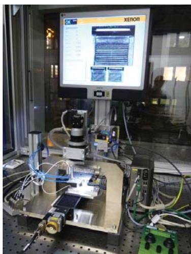
Versuchsaufbau für die automatisierte Mikromontage
